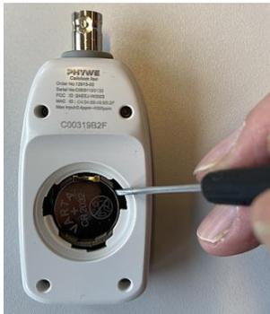
Hebeln Sie die Batterie gefühlvoll z.B. mit Hilfe eines kleinen Schraubendrehers oder einer kleinen Schere aus der Fassung. Setzen Sie den Schraubendreher so an, wie in der Abbildung zu erkennen ist.
