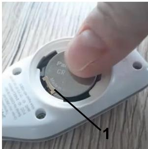
Schieben Sie die Batterie unter die goldene Metallnase (1). Achten Sie darauf, dass die Batterie komplett unter der Metallnase ist und komplett an den oberen Rand geschoben ist.
