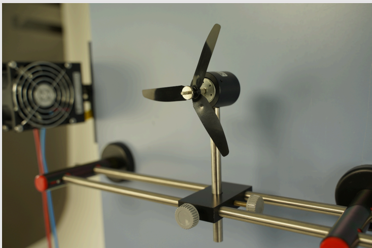
Versuchsteil 2: Windrad mit drei Rotorblättern
