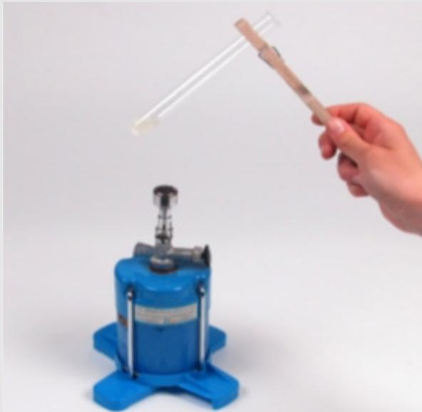
Налейте в пробирку на ширину большого пальца раствор яичного белка и осторожно нагрейте в пламени газовой горелки (рис. слева).
