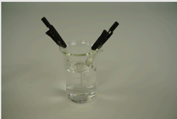
Befestigung der Elektrodenbleche am Rand des Becherglases.
