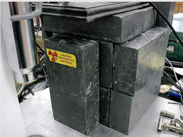
Durch Blei abgeschirmtes radioaktives Material
