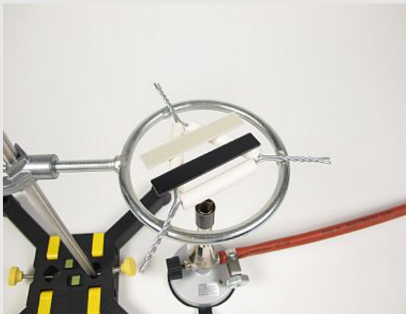
Untersuchung des Verhaltens von Thermo- sowie Duroplasten bei Erwärmung.
