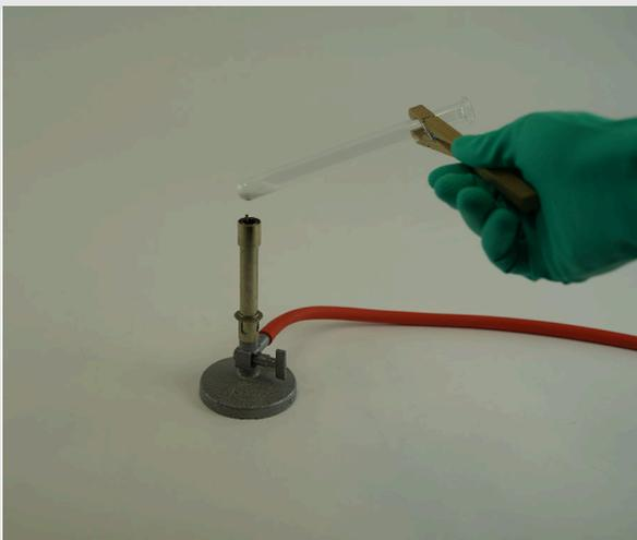
Mit Chemikalien befülltes Reagenzglas über dem Butanbrenner
