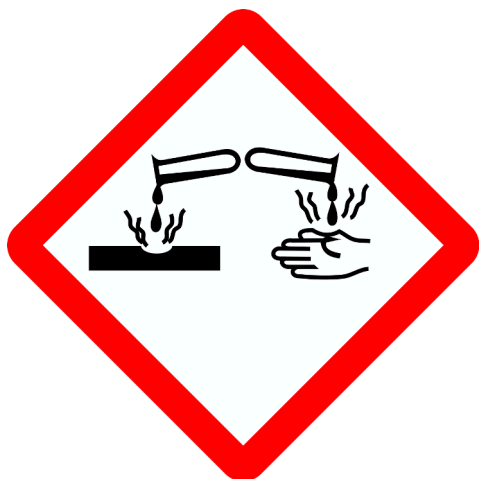
Símbolo de advertencia para sustancias corrosivas
