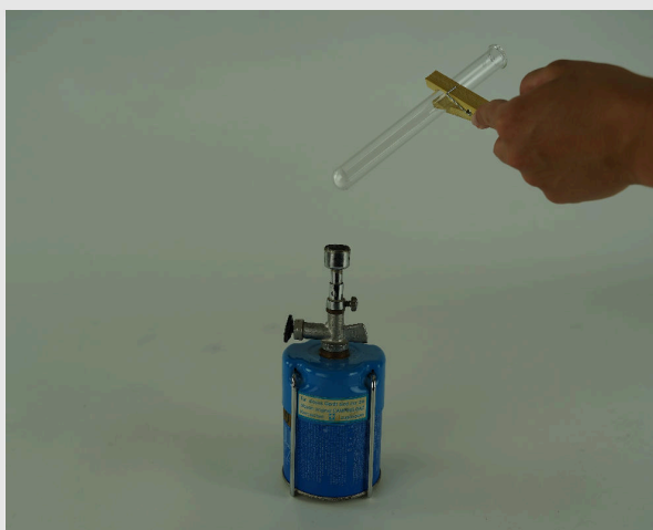
Calentar un tubo de ensayo sobre el quemador de butano
