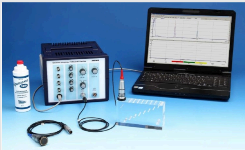
Рис. 1: Оборудование для ультразвуковой эхографии, экспериментальная установка
