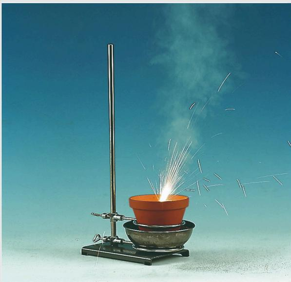
Las reacciones de la termita tienen muchos usos. La termita no es un explosivo. Funciona exponiendo un área muy pequeña a temperaturas extremadamente altas. Esto puede ser útil para cortar el metal o soldarlo.
