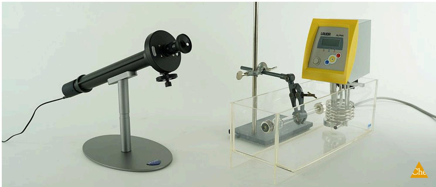
Ход реакции инверсии сахарозы сопровождается изменением угла поворота поляризованного света. В то время как глюкоза вращает плоскость поляризации линейно поляризованного света по часовой стрелке, а инвертный сахар - влево. Изменение угла поворота поляризованного света во времени измеряется с помощью полутеневого поляриметра.
