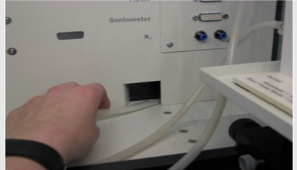
Рис.3: Трубки, проложенные через рабочий канал
