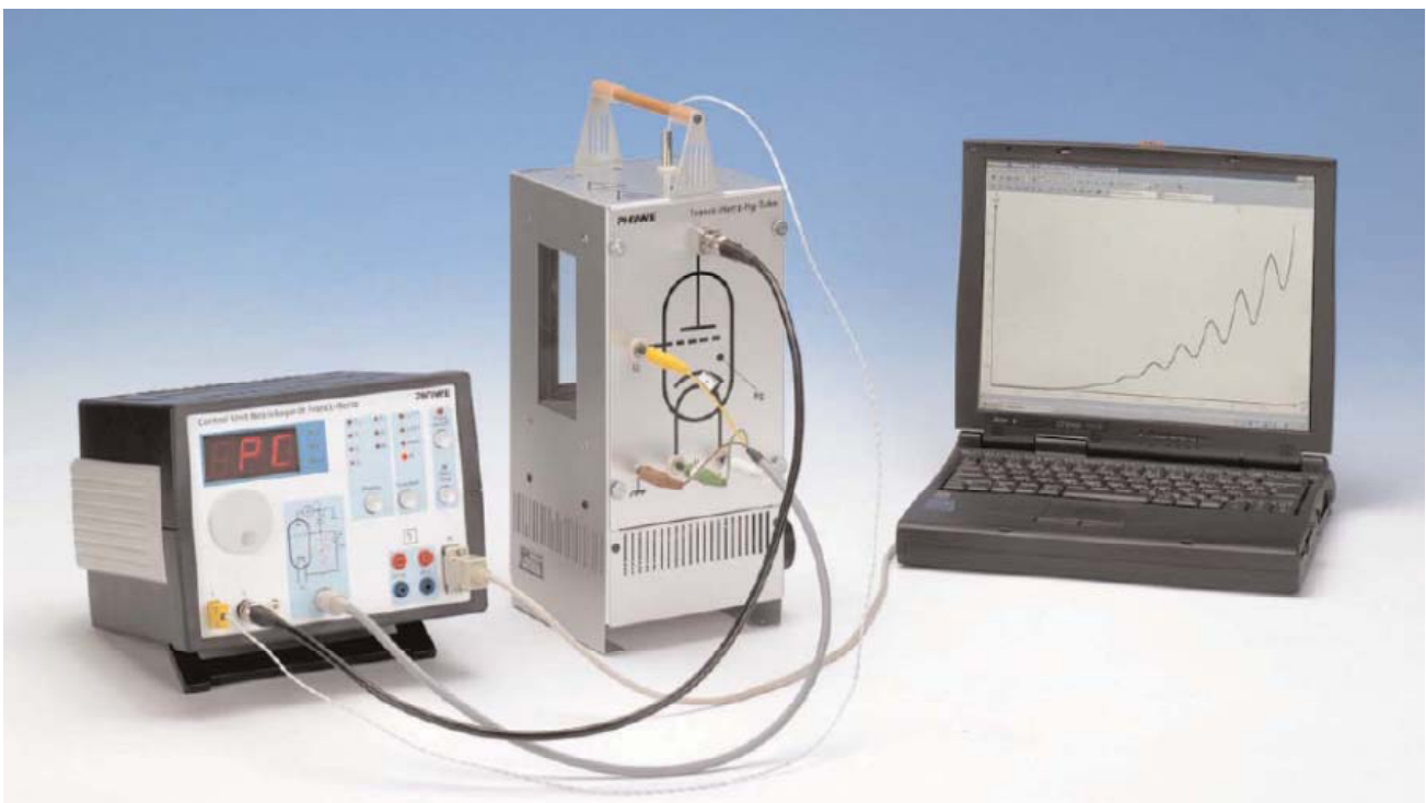
Abb. 1: Aufbau des Franck-Hertz-Experiments mit dem PC
