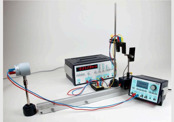
Fig. 3: Montaje experimental (tarea 2): detector en movimiento
