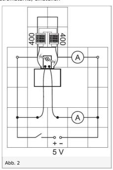
Schalter schließen und Motor belasten: Anker durch Fingerdruck auf die vordere Riemenscheibe abbremsen; dabei Drehzahl und Anzeige der Strommesser beobachten (6)
