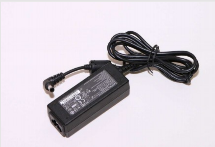
Netzteil - Anwendungsbeispiel eines Gleichrichters
