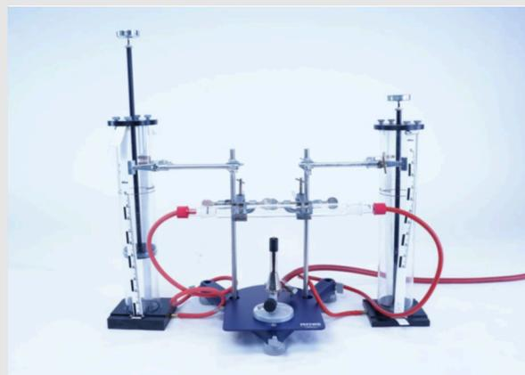
Achtung! Vor Durchführung der Reduktion ist die Apparatur mit Wasserstoff zu spülen.
