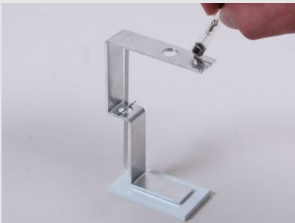
Elektroskop mit Glimmlampe untersuchen
