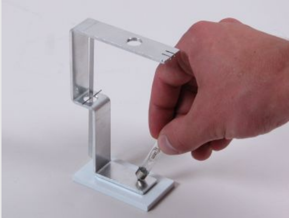
Elektroskop mit Glimmlampe untersuchen
