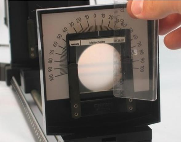
Измерение размера промежуточного изображения на экране матового стекла
