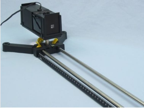
Расположение осветителя на оптической скамье
