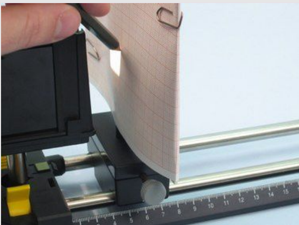
Marquage de la zone éclairée
