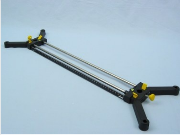
Montaje del banco óptico
