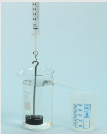
Détermination de la quantité d'eau déplacée par une masse
