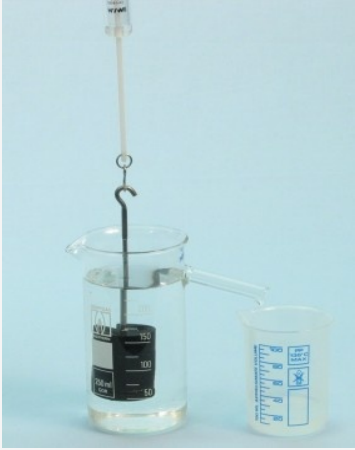
Détermination des forces de pesanteur dans l'eau
