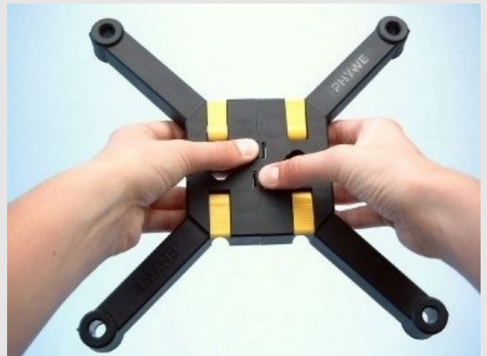
D montage de la base du tr pied
