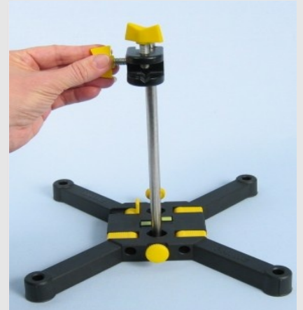
Fijando la doble nuez a la barra de soporte
