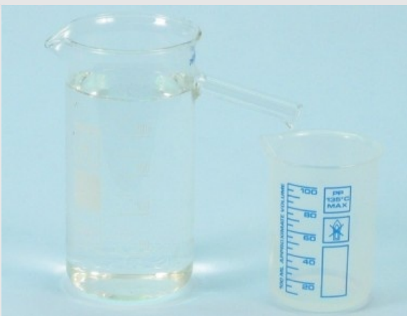
Llenando el recipiente de desbordamiento con agua
