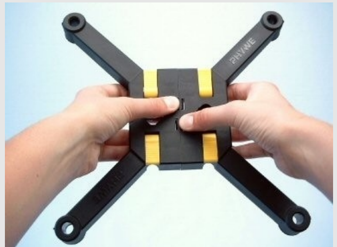
Demontage des Stativfußes
