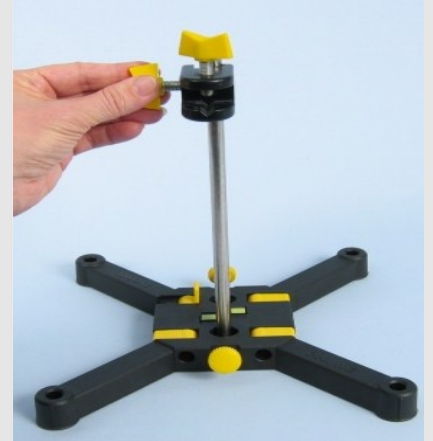
Anbringen der Doppelmuffe an der Stativstange
