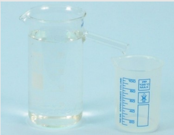
Befüllen des Überlaufgefäßes mit Wasser
