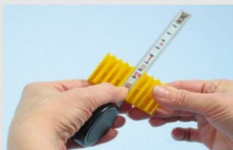
Fixation du mètre dans le support d'un tube de verre
