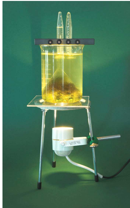
Versuchsaufbau zur Photosynthese aus Gerätesatz „Photosynthese“ (42150) und Beleuchtungseinrichtung (42151)
