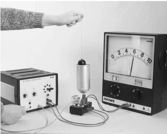
Abb. 2: Versuchsaufbau zur Messung von Ladung, die mittels einer graphitbeschichteten Kugel in einen Faraday-Becher eingefüllt wird.
