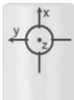
Die Pfeilrichtung stellt einen positiven Messwert dar. Somit wird das Magnetfeld der Erde als positives Feld registriert (x-Achse) wenn der Stab auf den magnetischen Nordpol der Erde zeigt.
