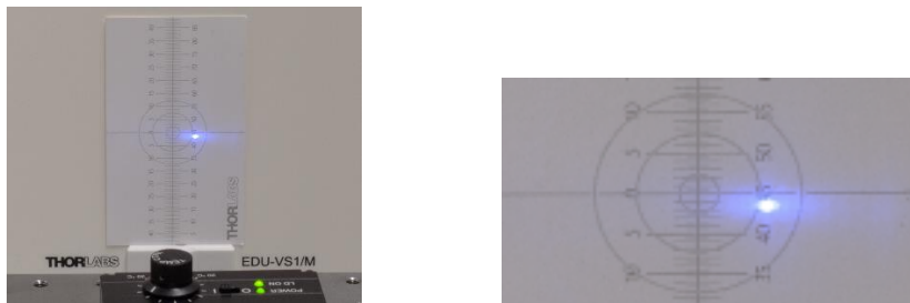
Abbildung 59 Laserpunkt auf dem Schirm nach der Kollimation (links) und vergrößerte Ansicht (rechts) 54
