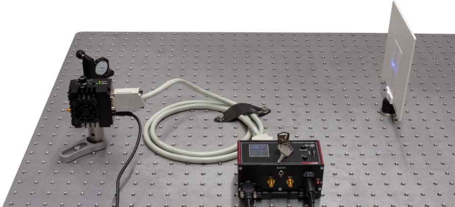
Abbildung 60 Kollimationsaufbau zur Kompensation abweichender Emissionswinkel
