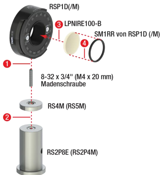
Abbildung 51 Zusammenbau des großen Polarisators
