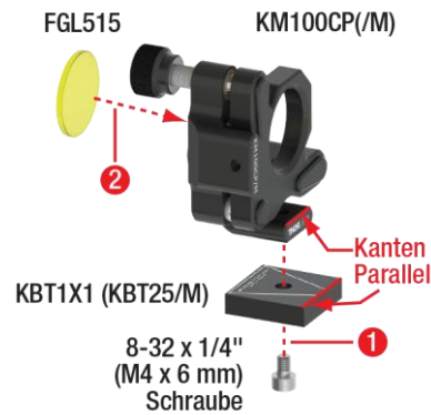
Abbildung 38 Zusammenbau des Glasfilters
