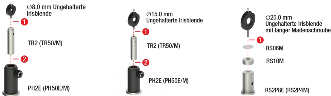
Abbildung 33 Aufbau der Irisblenden
