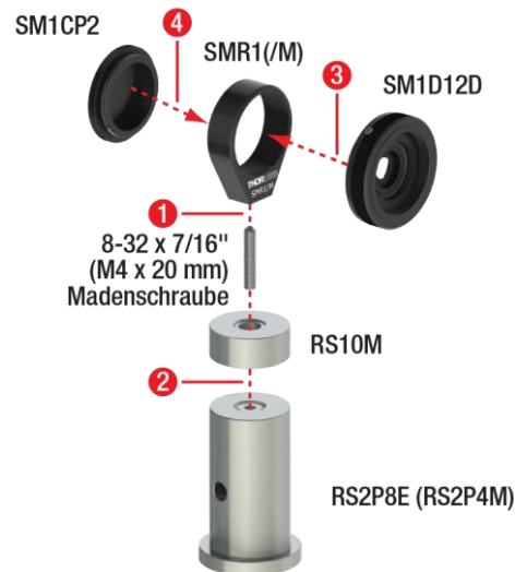
Abbildung 42 Zusammenbau der Strahlfalle
