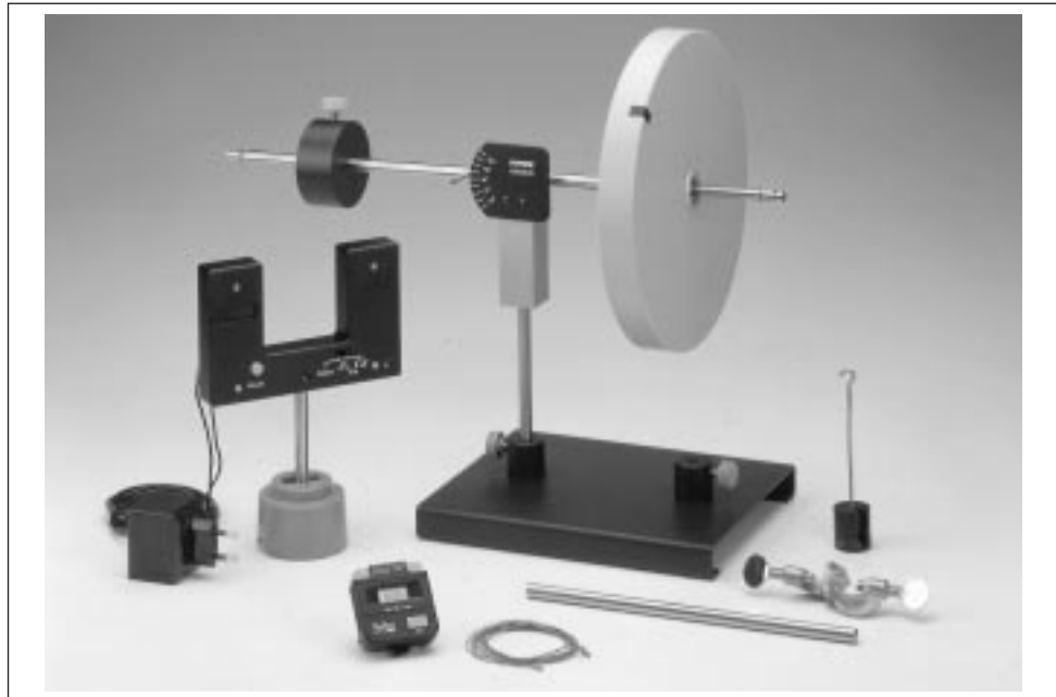
Abb. 1: Materialzusammenstellung für quantitative Messungen zur Physik des Kreisels gemäß Geräte-Liste (Abschnitt 5).
