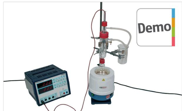
**Quantitativ:** Bestimmung molarer Massen durch Messung der Siedepunktserhöhung (Ebullioskopie) (P1136000)
