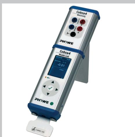
Die Cobra4 Sensor-Unit Strom/Spannung verfügt über einen elektronischen Überlast-Schutz bis 100V und einen Spannungsdifferenz-Eingang. Ströme und Spannungen können damit einfach und sicher gemessen werden.
