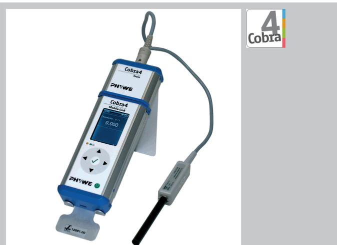
Mit der Cobra4 Sensor-Unit Tesla kann die magnetische Feldstärke von Gleich- und Wechselfeldern gemessen werden, z.B. das Magnetfeld von Spulen oder Permanentmagneten. Die axiale Sonde ermöglicht auch die Messung im Inneren einer Spule.
