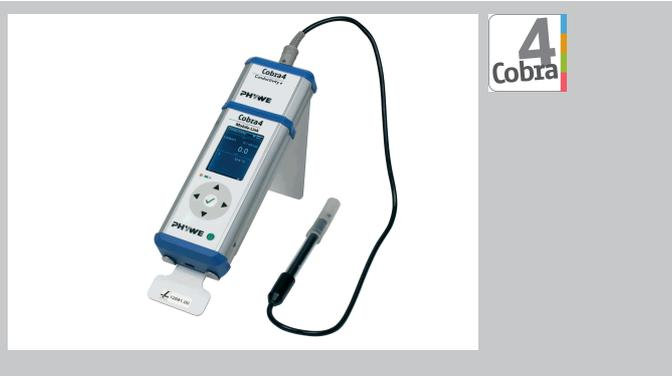
**Cobra4 Sensor-Unit Conductivity+, Leitfähigkeit / Temperatur Pt100**
