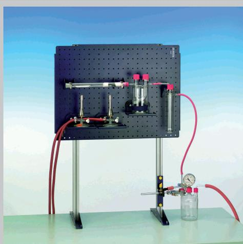
In diesem Versuch wird ein Verfahren nachvollzogen, das in der Industrie angewendet wird. Beim Verbrennen von Schwefel entsteht Schwefeldioxid, das am Platinkatalysator zu Schwefeltrioxid oxidiert wird.
