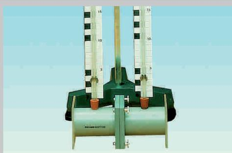
Die beiden Kammern der Osmosezelle sind durch eine Membran getrennt. Eine Kammer wird mit Zuckerlösung, die andere mit Wasser gefüllt. Durch das Eindringen der Wassermoleküle in den geschlossenen Raum mit der höheren Konzentration an gelöstem Stoff entsteht ein Überdruck, der anhand der Veränderung der Flüssigkeitsmenisken in den Kapillaren demonstriert wird.
